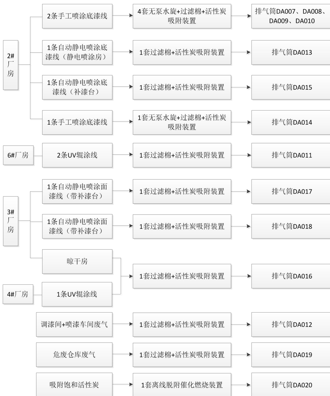
图 4.2-2 油漆废气处理及排放流程图
